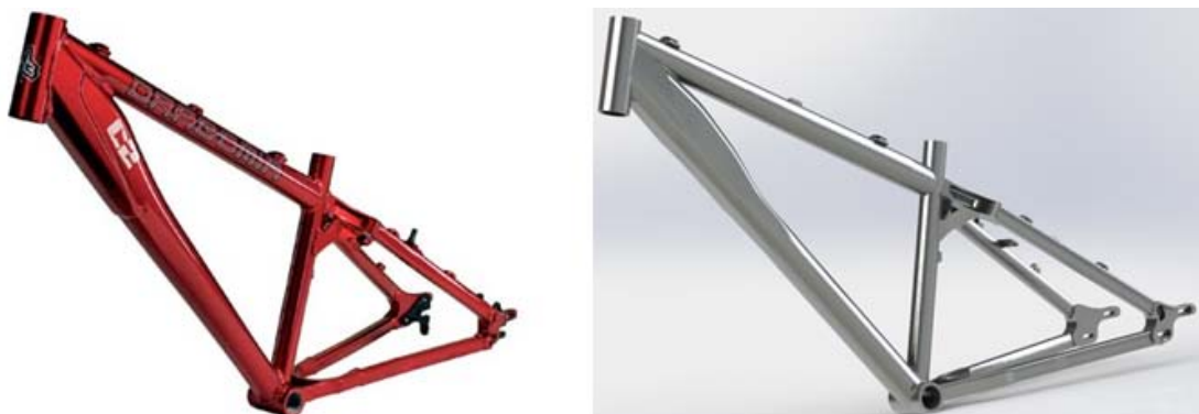
Фиг.1 а) Реална велосипедна рамка от фирма Drag б) Виртуален модел на рамката
