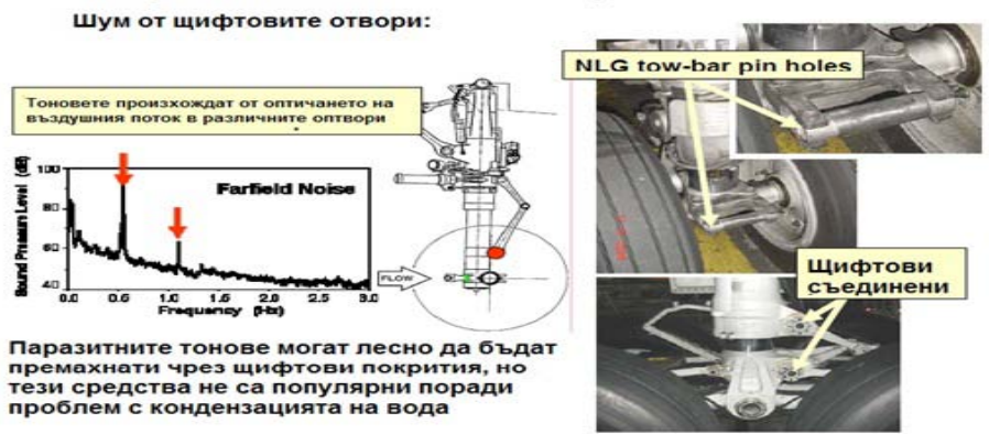
Фиг. 4. Паразитни източници на шум от колесника
