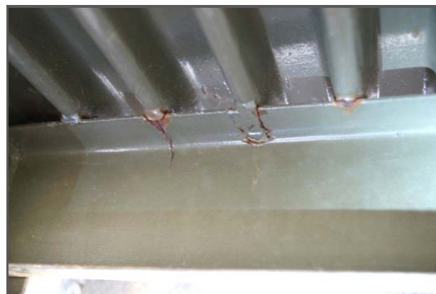
Фото 6. Развитие трещины до продольной
