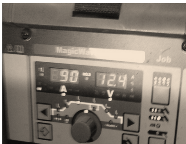
Фиг. 1 Импулсна апаратура Fronius Magic Wave 2500 за ВИГ заваряване и наваряване.
