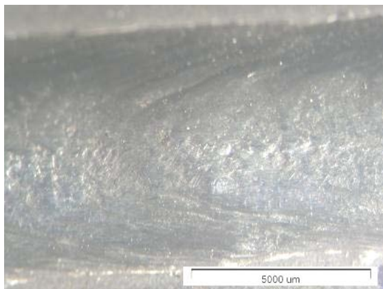
Фиг.4а. Общ вид на заваръчен шев, обр. №1, СМ
