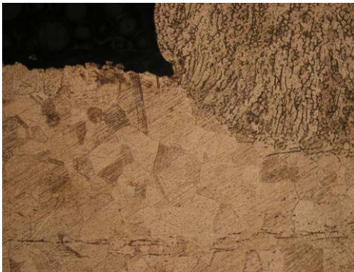
Фиг. 6. Несъвършенства в преходите от метала на шева към основния метал, Ляв и десен край на шева, ОМ
