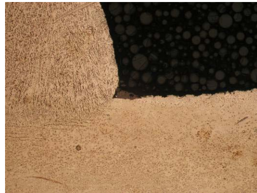
Фиг. 6. Несъвършенства в преходите от метала на шева към основния метал, Ляв и десен край на шева, ОМ
