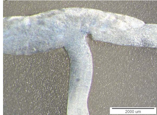
Фиг.5б. Макроструктура на обр.№2, СМ. От фотографията са определени: ширината на заваръчния шев, височината му и дебелината на заварявания материал в mm.: V=5.42+0.03 mm ; h=0.63+0.14 mm ; d=1.04+0.02 mm
