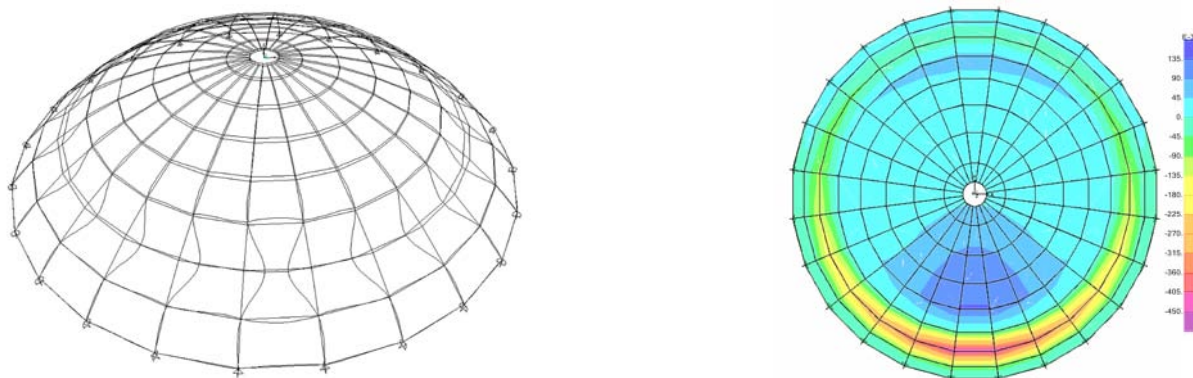
Фиг. 9. Повърхнина на влияние за нормално усилие в елемент N2 от купол K.1, построена по кинематичен метод
