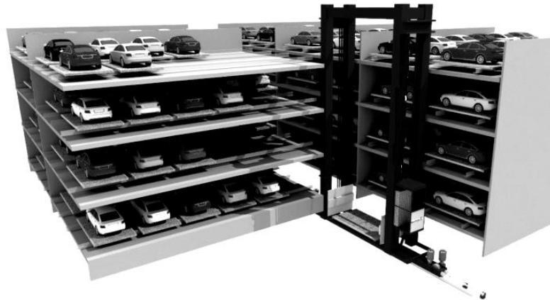
Фиг.2 Автоматизиран многоетажен-паркинг гаража, обслужван от трансманипулатор
