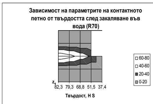
Фиг. 4. Параметри на контакт при радиус на контакт R70
