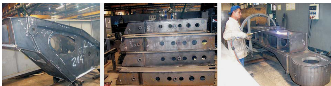
Фиг.1 Заварени конструкции от стомана S 960 QL
