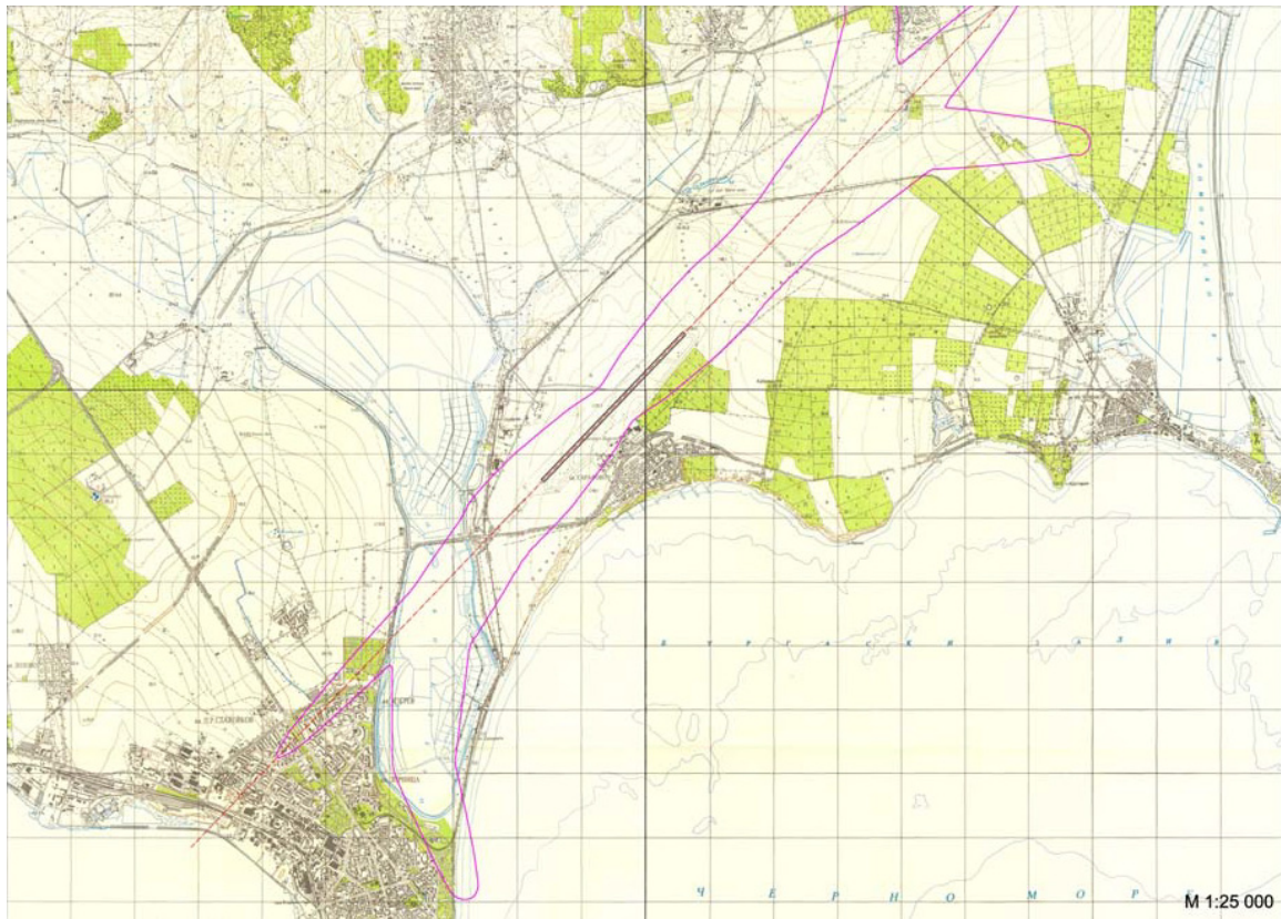
Фиг. 2. Летище Бургас. Контур на максималното ниво на шума, L_{\text{MAX}} = 85\text{dB(A)}
