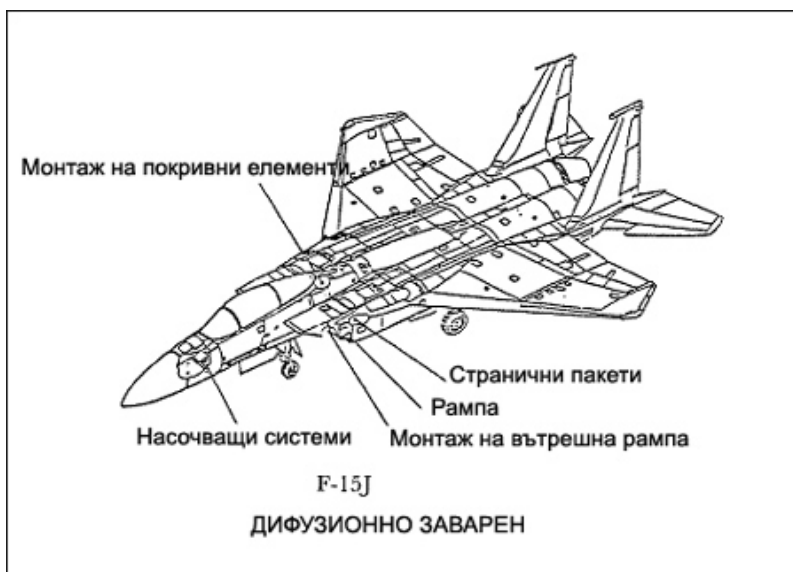
Фиг.1 Дифузионно-вакуумно заварени възли в самолет
