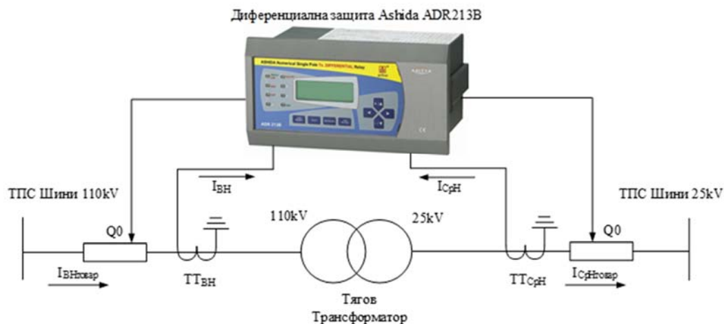
Фиг. 2. Принципна схема на диференциална защита на тягов трансформатор с реле ADR213B
