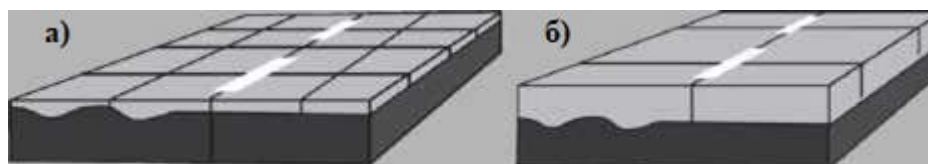
Фиг.1. Свързано а) и несвързано б) бетонно пренастилане върху съществуваща асфалтова настилка [4]
