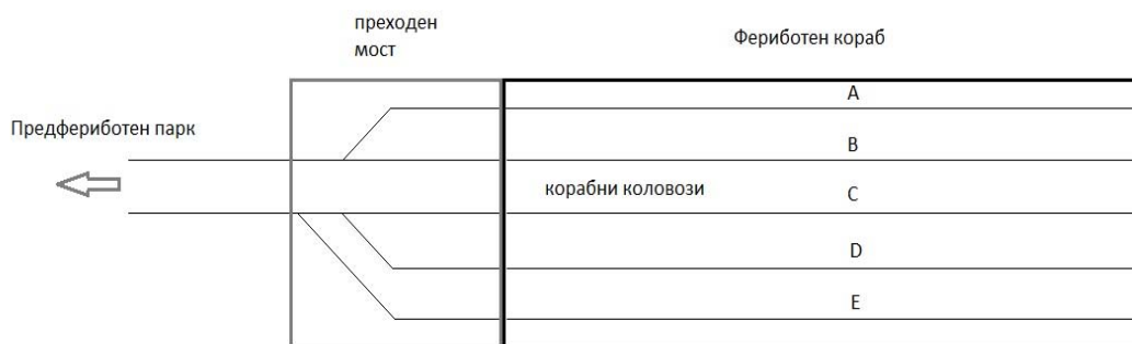
Фиг. 2. Схема на коловозното развитие на преходен мост и палуба на фериботен кораб
