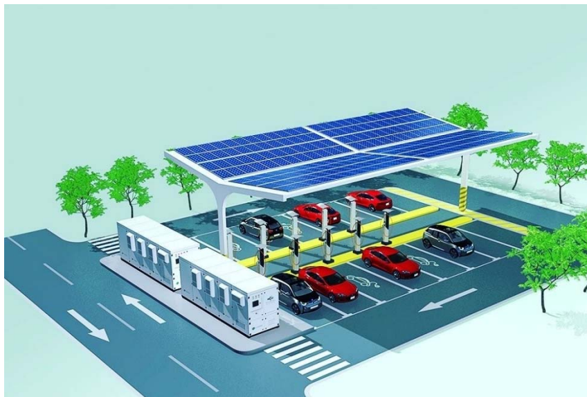
Фиг. 4. Хибридна зарядна станция 360kW/1000Vdc/ BESS 600kWh/ PV 200kWp MPPT, снабдена с 10 зарядни колонки по 180kW/250A тип CCS2.
