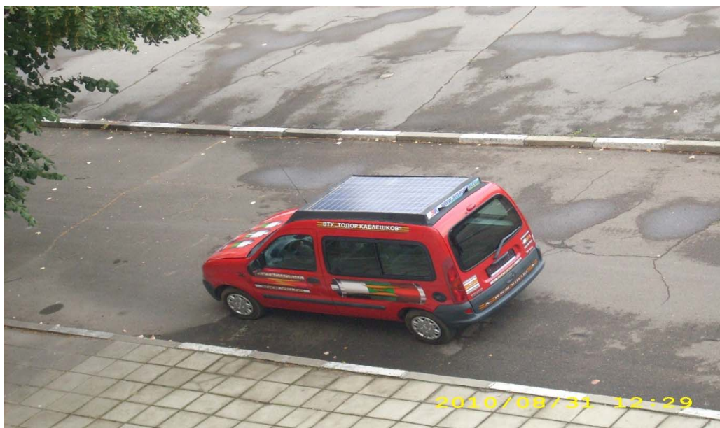
Фиг. 3. Соларен панел на покрива на електромобил Рено Канго – 2010г.
