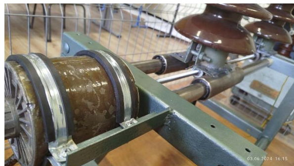
Фиг. 2. Електрозадвижване за приближаване и отдалечаване на електродите
