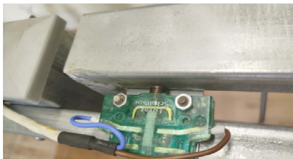
Фиг. 6. Краен изключвател на вратата на изпитателното поле
