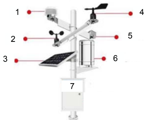
Фиг. 2. Общ вид на системата за следене на атмосферни условия
