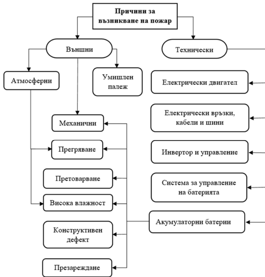
Фиг. 2. Блок-схема на причините за възникване на пожар в автономни електрически транспортни средства
