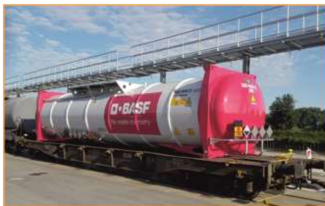
Фиг. 5. Супер-голям контейнер-цистерна на BASF
