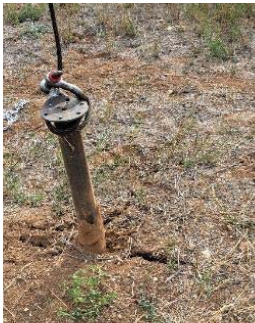
Фиг. 3. Видове разрушения в почвата а) разрушение с напукване на почвата; б) изтръгване на пилота около винта
