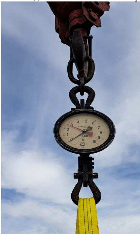
Фиг. 2. Провеждане на изпитването а) отчет по динамометъра; б) изпитан пилот, изтръгнат с автокрана
