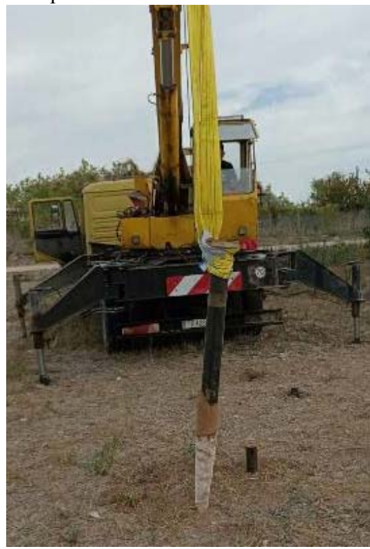
Фиг. 2. Провеждане на изпитването а) отчет по динамометъра; б) изпитан пилот, изтръгнат с автокрана
