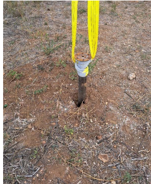
Фиг. 3. Видове разрушения в почвата а) разрушение с напукване на почвата; б) изтръгване на пилота около винта
