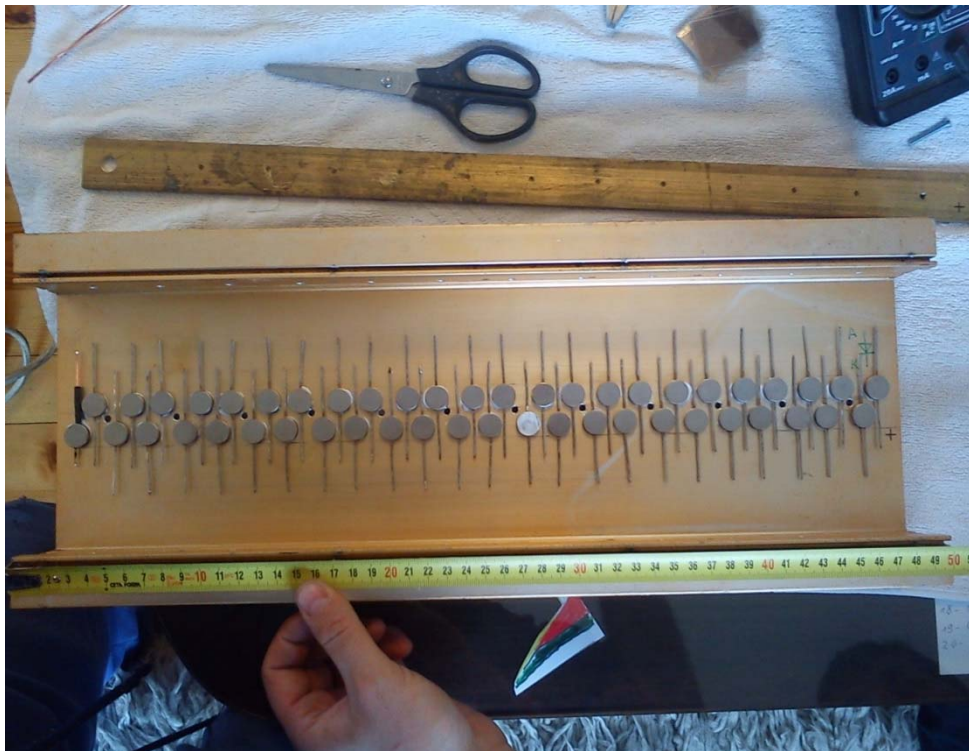
Фиг. 2. Разположение на 48-те импулсни диода върху алуминиевия охладител
