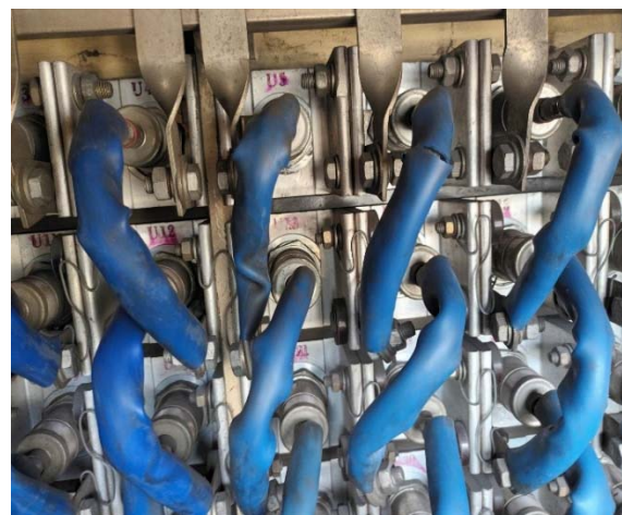
Фиг. 2. Изправителен шкаф на електрически локомотив серия 44, 45
