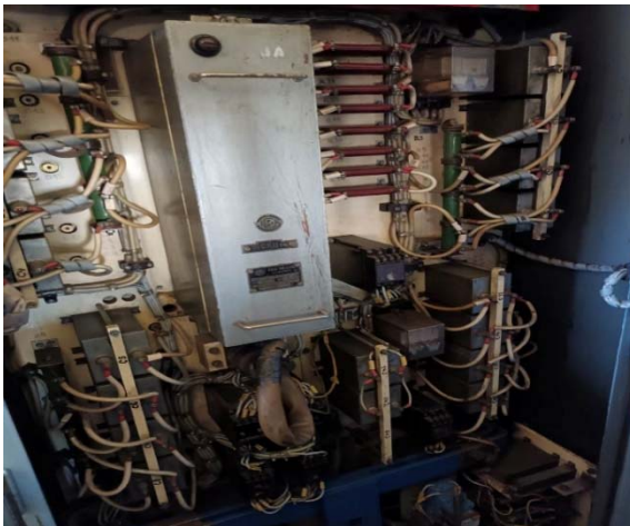
Фиг. 2. Изправителен шкаф на електрически локомотив серия 44, 45
