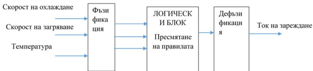
Фиг. 1. Структура на системата на размита логика
