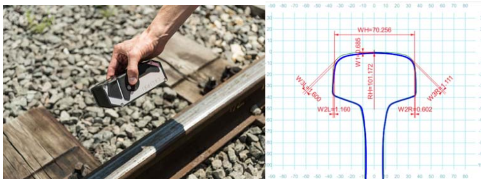
Фиг.3. а) – Уред за измерване на профил на релсата Calipri [10]; б) – Параметри за определяне на износване [10]
