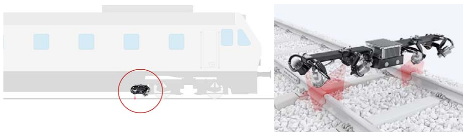
Фиг.4. Система за автоматизирано измерване на профила на релса при движение[11]
