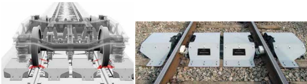
Фиг.6. Система за автоматизирано измерване на профила на бандажите[12]
