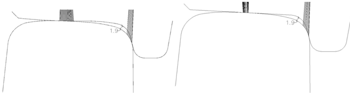
Фиг.8. Стойност на хлабината при профил PRSf 2018 (отляво) и T81 (дясно) с релса 49E1- 1435 mm
