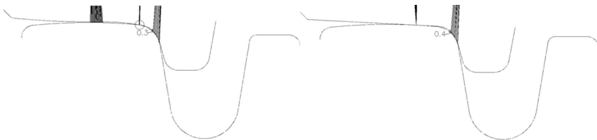
Фиг.10. Стойност на хлабината при профил PRSf 2018 (отляво) и T81 (дясно) с релса 60R1 – 1435 mm
