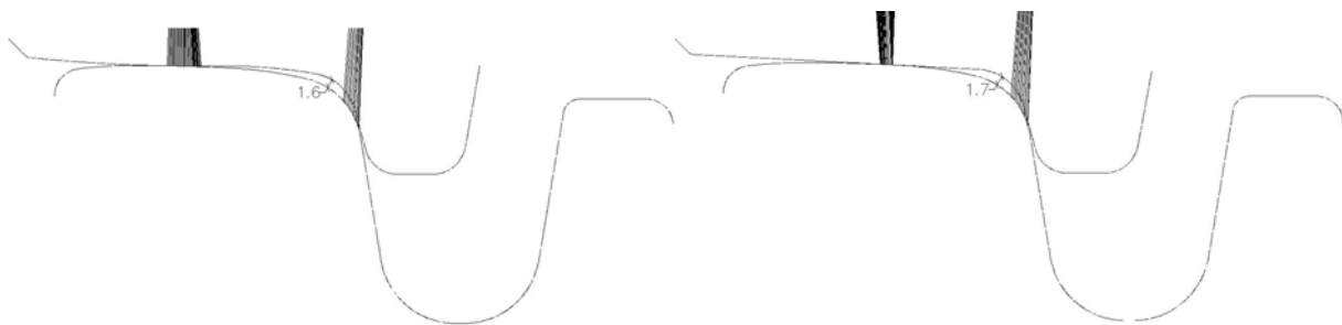
Фиг.9. Стойност на хлабината при профил PRSf 2018 (отляво) и T81 (дясно) с релса 60R2 – 1435 mm
