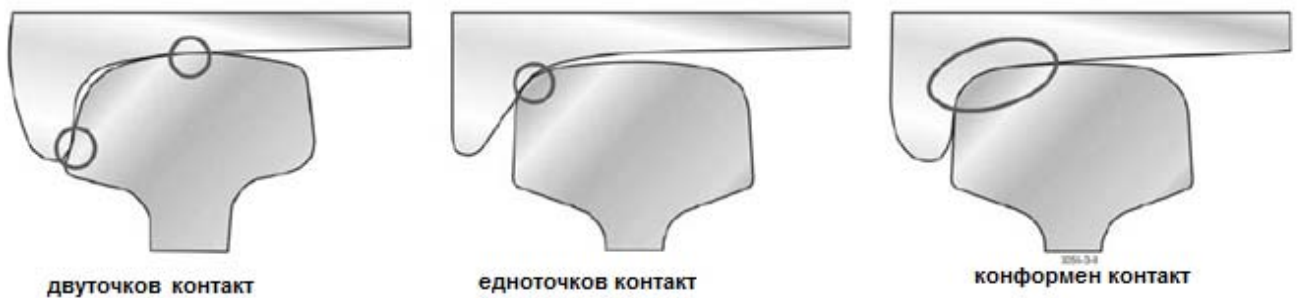
Фиг. 4. Видове контакт между фланеца на колелото и страничния ръб на релсата [8]
