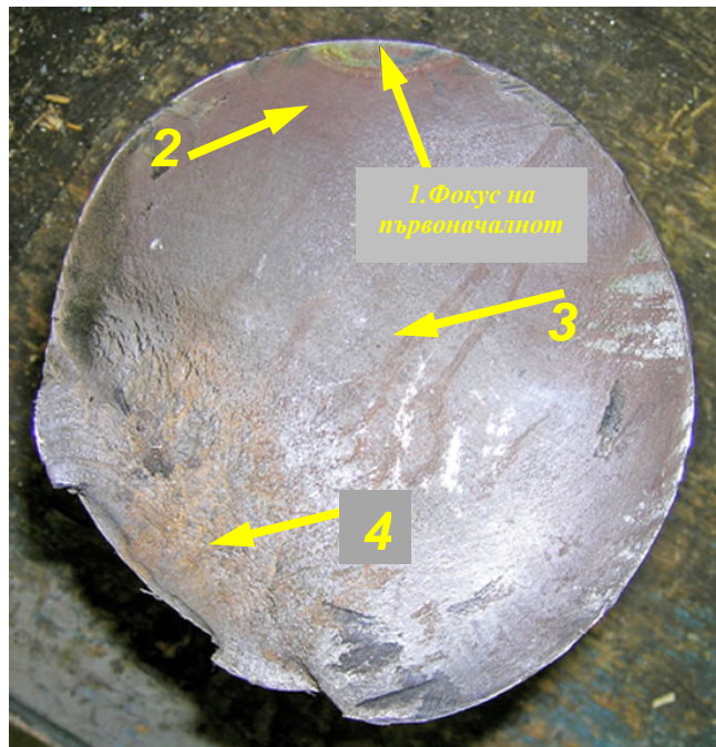
Фиг. 6. Лом на осна шийка, предизвикан от недостатъчна динамична якост (умора на материала). (снимката е илюстративна)
