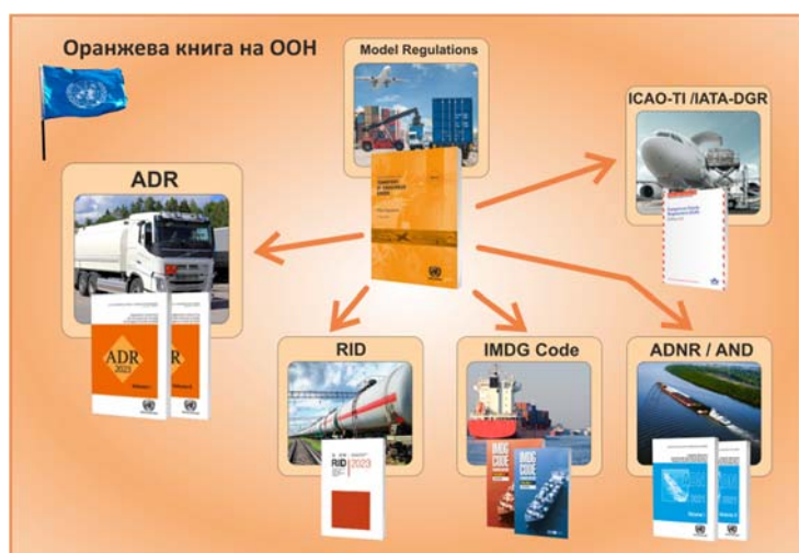
Фиг. 3. Оранжева книга и нейната връзка с разпоредбите за опасни товари по видове транспорт
