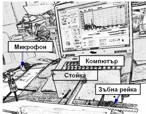
Фиг. 6. Изображение на момент от изследване на зъбната рейка.
