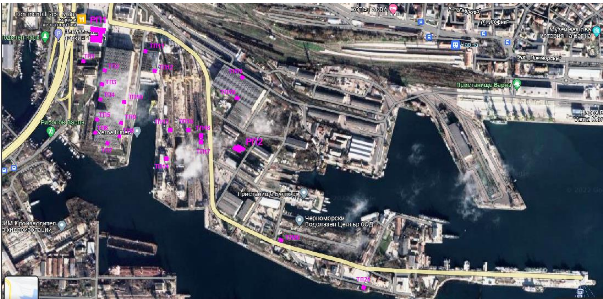
Фиг.2 План разположение на основните звена от вътрешната електроснабдителна система на завода – разпределителни подстанции (РП) и трансформаторни подстанции (ТП).
