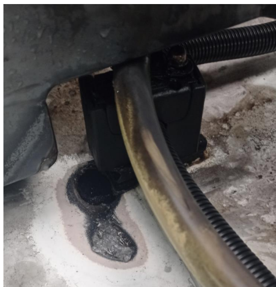
Фиг. 2. Изолационна скоба със заземителен кабел и кабел за управление на електрическия двигател за повдигане и сваляне на пантографа
