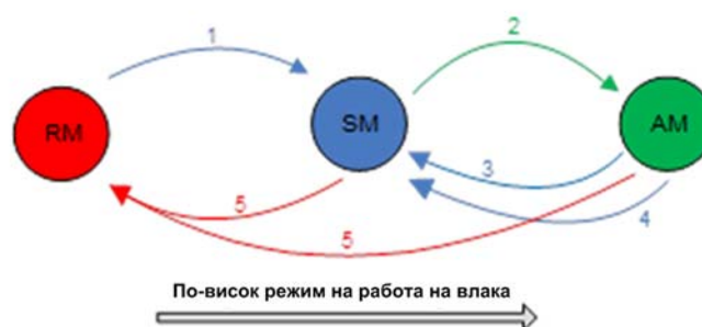
Фиг. 2. Йерархия и връзки между основните режими на работа на метровлакове Siemens Inspiro
