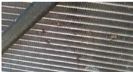
Фиг. 6. Запушване на охлаждащия радиатор с насекоми
