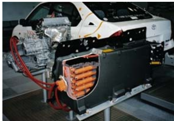
Фиг. 8. Литий-ферофосфатна \text{LiFePO}_4 акумулаторна батерия на Тойота Приус.
