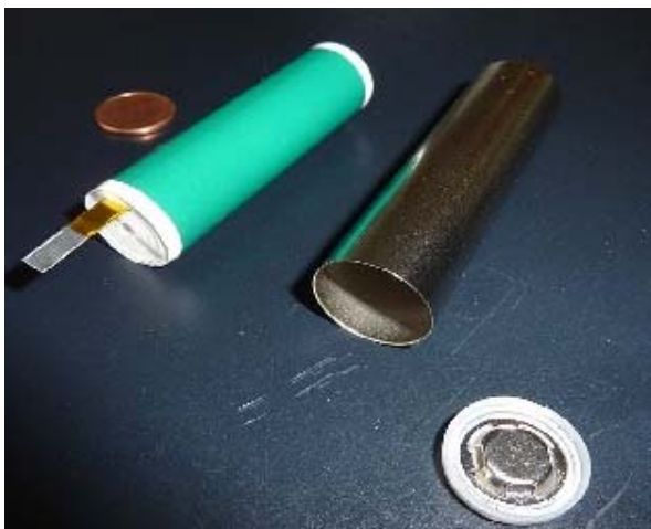
Фиг. 1. Устройство на литиевойонна батерия
