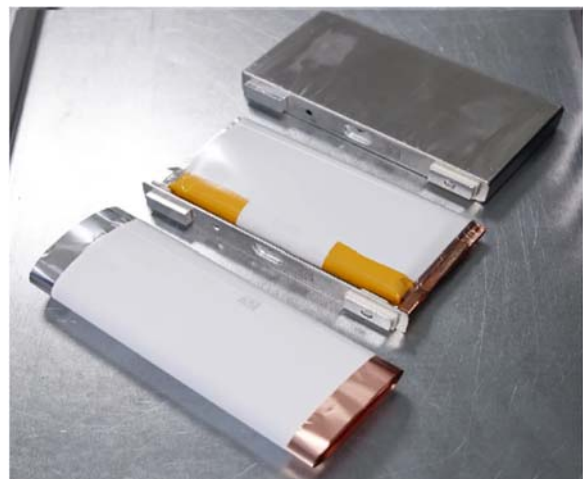
Фиг. 1. Устройство на литиевойона батерия
