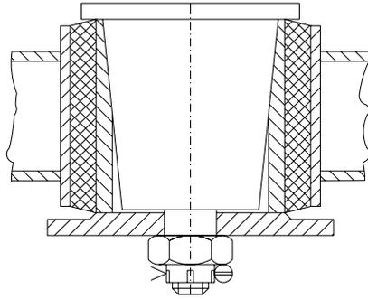
**Fig. 5. Metal-rubber springs.**
