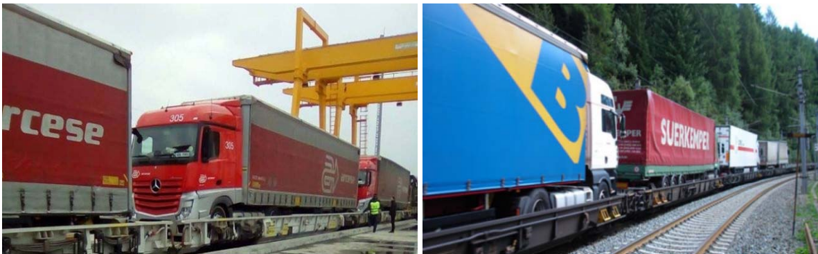
Фиг. 3. Транспортиране на камиони чрез системата RoLa
