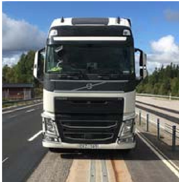
Фиг. 8. Контактни шини, вградени в повърхността на пътя
