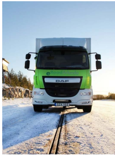
Фиг. 1. Токоснемане посредством контактна релса
