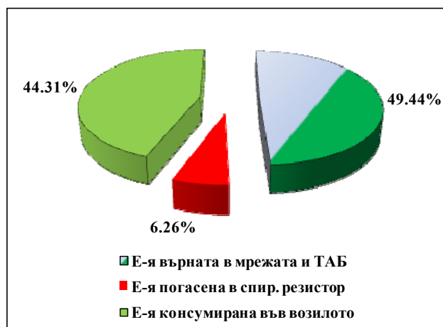
Фиг. 4. Диаграма на средното относителното разпределение на регенеративната енергия между вътрешните потребители, спирачния резистор и тази върната тяговата мрежа и съхранена в тяговата акумулаторна батерия
