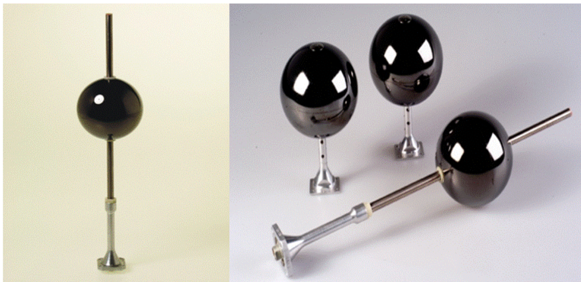
Фиг. 1 образци на сферични сензори от графит, покрити със стъкловъглерод, за измерване на постоянни и променливи електрични полета, от борда на космически апарати в околосемната плазма.
