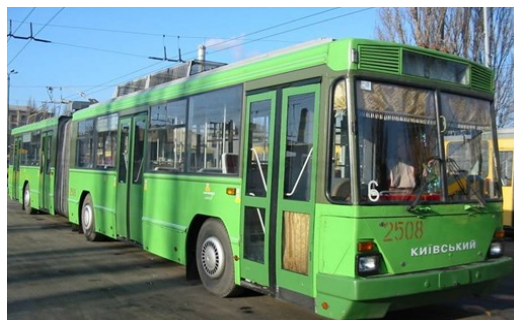
Фиг. 2 Тролейбус K12.03 "Київський" с алуминиева рамка и корпус
