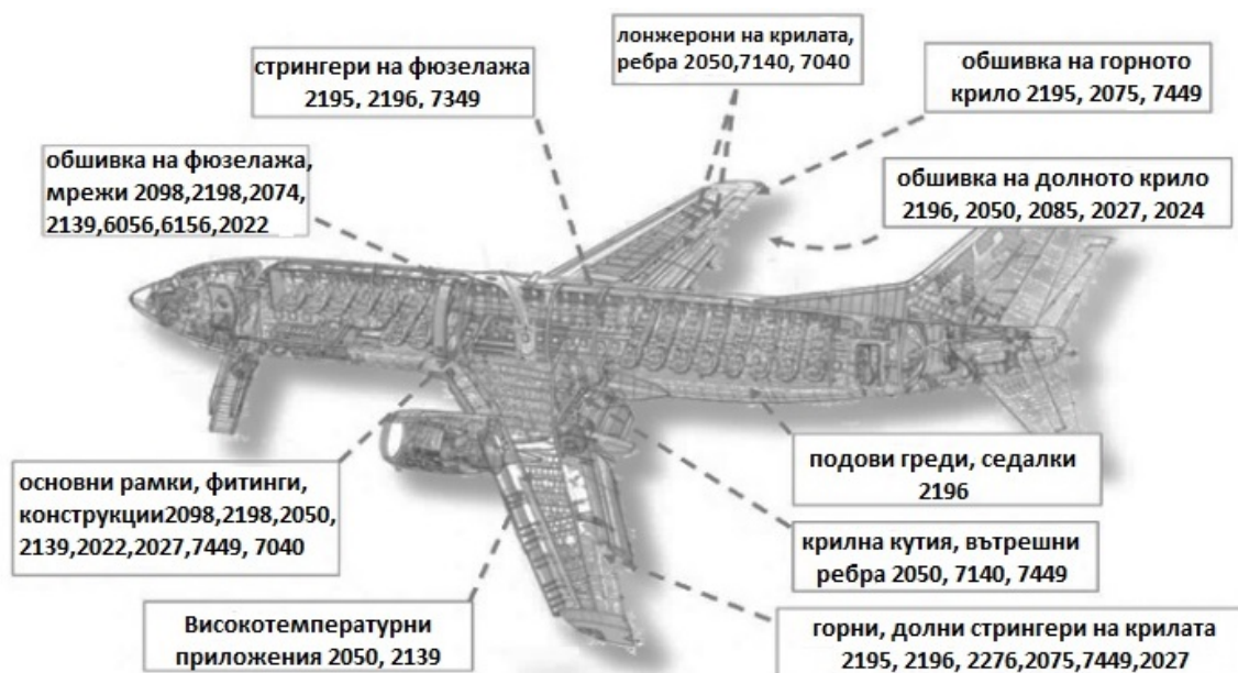
Фиг. 3. Алюминиеви сплави, използвани в различни части на конструкцията на самолет [10]
