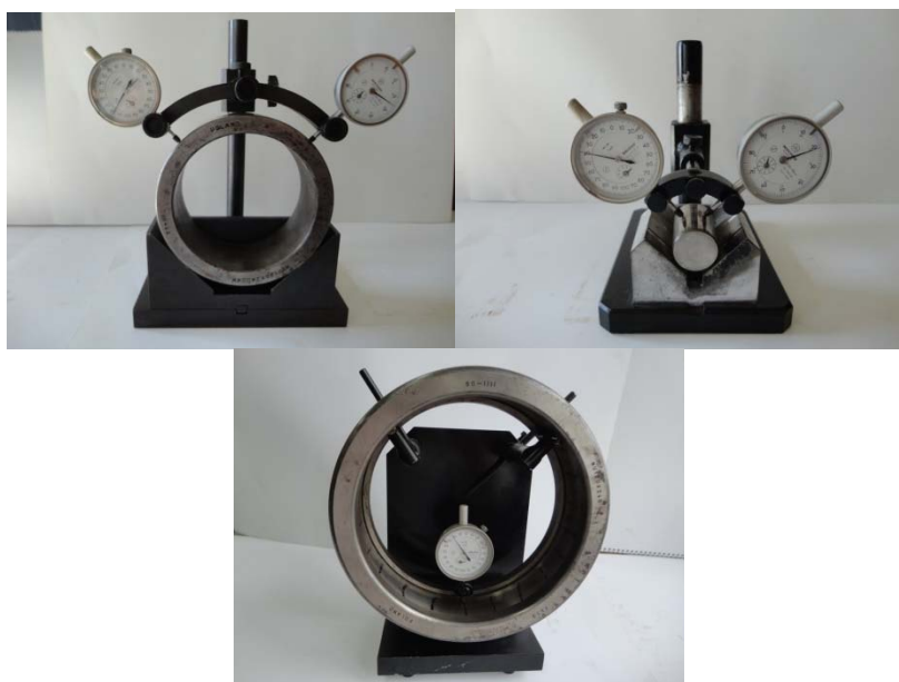
Фиг. 4 Приспособления за измерване отклоненията от допусковите полета на размерите на външни и вътрешни пръстени и ролки на буксови ролкови лагери
