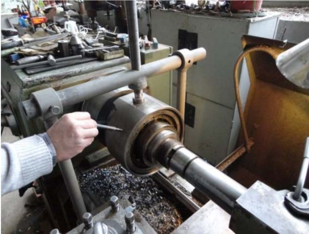
Фиг.1 Регистриране на виброакустични сигнали от въртящ се буксов ролков лагер
