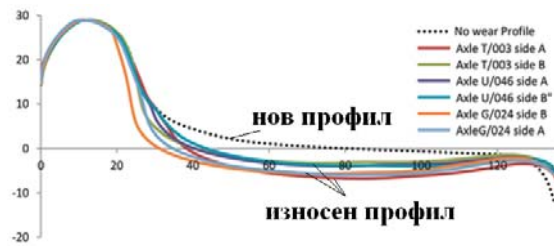
Фиг. 2. Характер на износване на колело от железопътна колоос [8].
