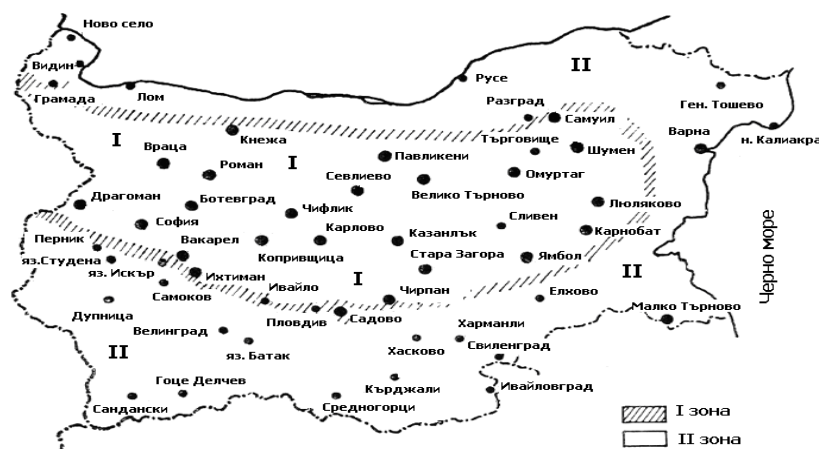
Фиг. 4 - Карта за интензивността на оразмерителните дъждове при една и съща повторяемост
