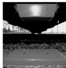
Фиг. 3. Типично изображение на бализна антена и бализа
