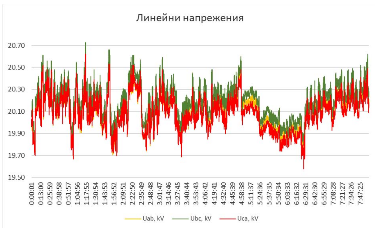
Фиг. 6 КРУ 1, киля №13 – линейни напрежения на висока страна на тигелна пещ
