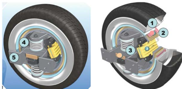
Фиг. 4 Конструкция на мотор-колело eCorner на Siemens VDO (сега Continental ): 1 - колело; 2 - електродвигател; 3 – спирачен механизъм; 4 – активно окачване; 5 – електрически механизъм за управление на завиването [14].
