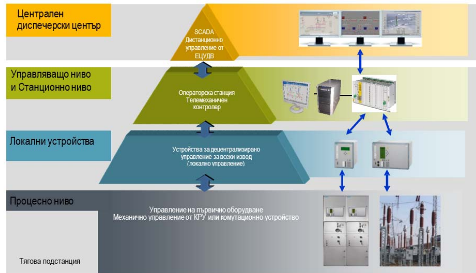
Фиг. 1. Иерархични нива на SCADA на ТЕС.
