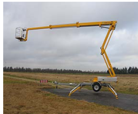
Фиг. 3 Прикачна подвижна работна площадка с шарнирно-съчленена телескопично изнасяща се стрела
