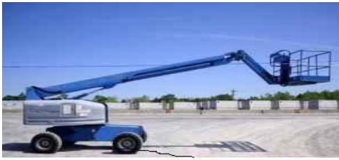
Фиг. 4 Самоходна подвижна работна площадка с телескопично изнасяща се стрела
