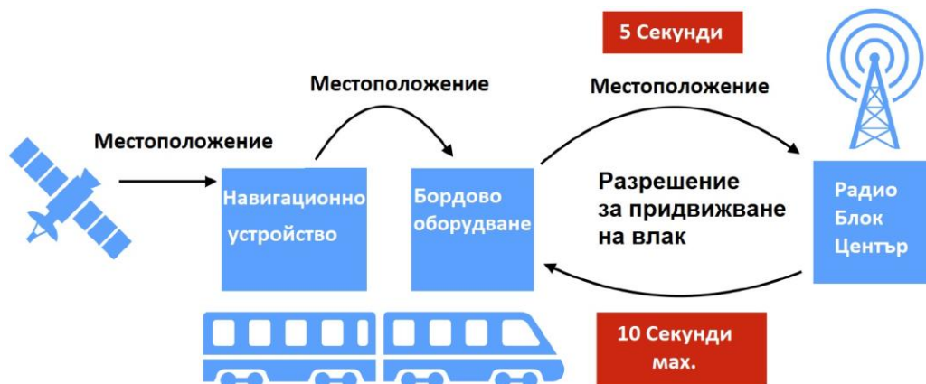
Фиг. 4 Преглед на ERTMS железопътна сигнализация с подвижен блок-участък
