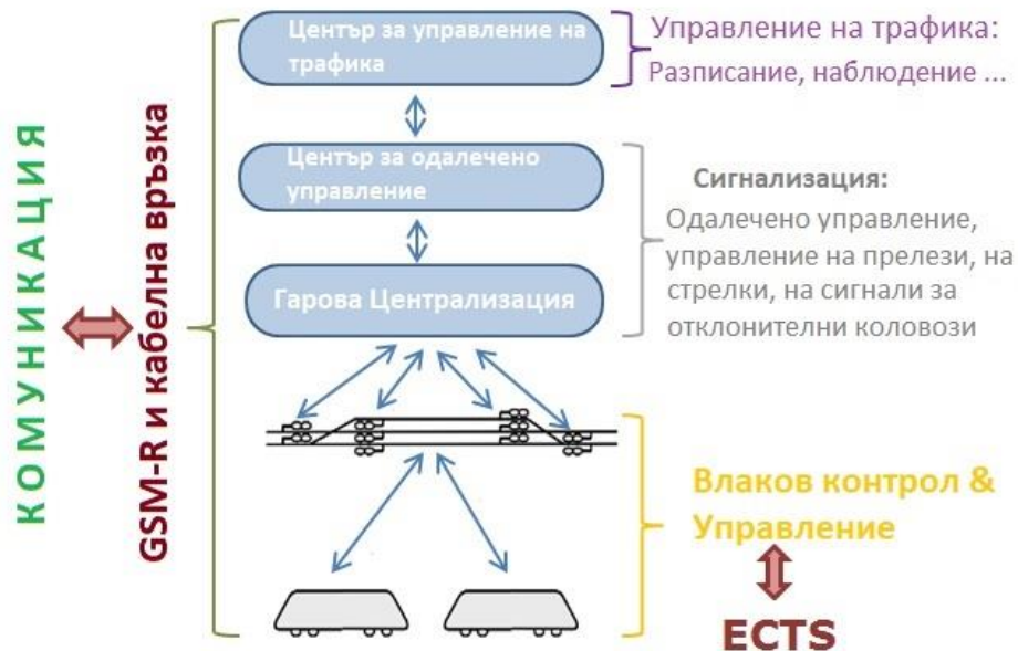
Фиг. 1 Функционална структура на ERTMS
